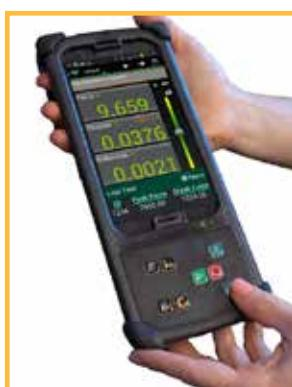
通过蓝牙连接设备的手持无线操作界面。该操作界面采用基于安卓的操作平台，可用于单独控制设备，或结合Tinius Olsen的Horizon软件进行控制。
