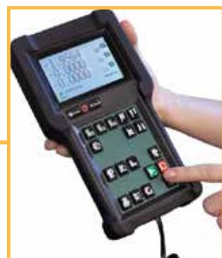
通过缆线连接设备的普通手持式操作界面。这种界面带有较大的物理密封式键盘，非常适用于操作者戴手套装卸试样从而更倾向于使用按键式键盘的情况。它需要在一台连接的电脑上运行虚拟机控制软件来操作基本的设备功能和报告基本的数值型测试数据。
