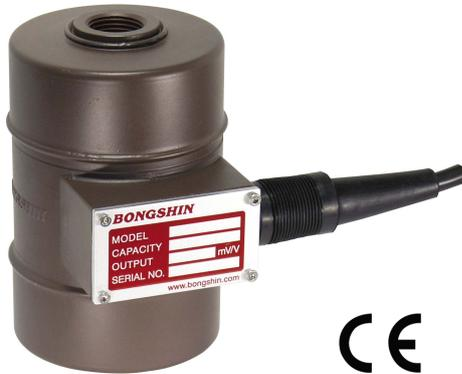
TR系列传感器可测量高达20吨的负载载荷，适用于工业应用。高合金材料结构，非重复性误差小，高灵敏度输出（3mV/V），低变形。使用时应配合使用杆端球接头。
