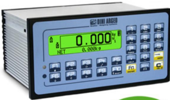
工业专用多功能微控制器/称重显示器, 配有16输出、8输入、3个RS232/RS485串口、16位模拟输出、Sysway传输协议、Modbus RTU协议, 其大量软件应用功能使其适用于自动化配料、控制和检重系统, 还提供经CE-M认证型号(OIML R-76 / EN 45501)。
